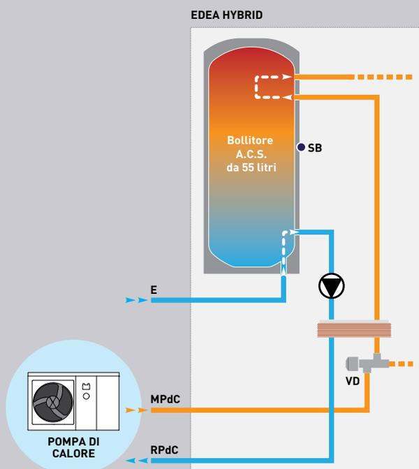
Il posizionamento degli attacchi idraulici scambiatore-bollitore permette di convogliare il calore generato direttamente nella zona più alta dell'accumulo consentendo così di sfruttare senza ritardi tutta la potenza della pompa di calore durante i prelievi sanitari.
